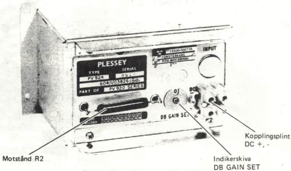
Bild 5. Förstärkaren sedd bakifrån
